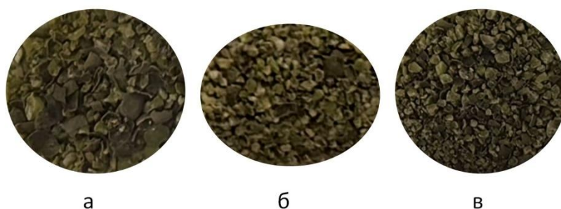
Рис. 2. Влияние количества семян в навеске на качество помола в лабораторной мельнице: а) помол 10 семян (крупнозернистая, гетерогенная фракция); б) помол 30 семян (гомогенная фракция); в) помол 40 семян (равномерный порошок с присутствием средней фракции)
