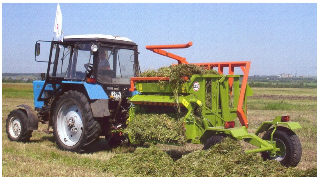
Рис. 4. Резчик рулонов «ИРК-01.1» в работе ( https://universal-agromarket.ru/catalog/kormorazdatchiki/820/?ysclid=lt1uxsnd87193674021 )
