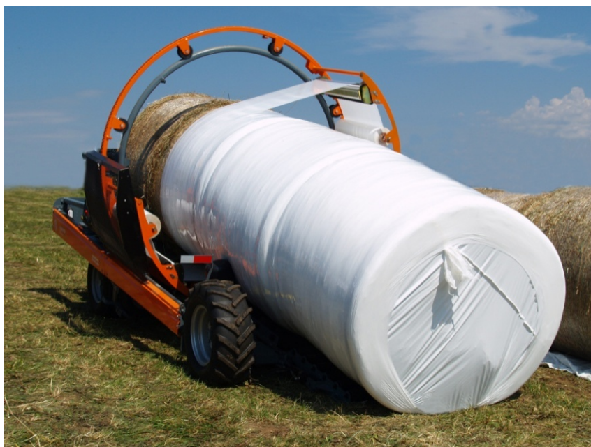
Рис. 3. Скоростной упаковщик рулонов «NEOLINER NWS 660» ( https://nm-agro.ru/catalog/upakovshchiki_rulonov/nws660/271/ )
