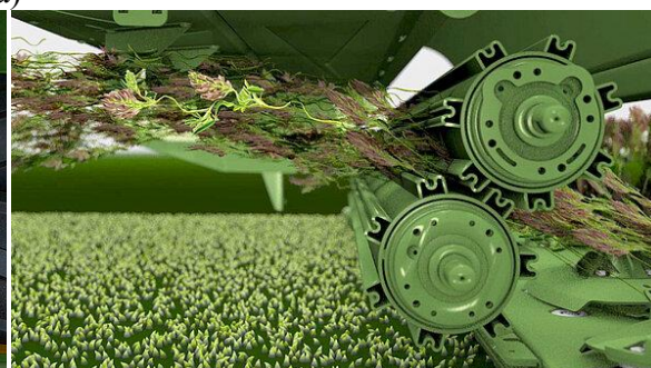
Рис. 2. Кондиционеры динамического действия фирмы KRONE, Германия ( https://www.krone-rus.ru/katalog-produkcii/diskovye-kosilki/easycut-f ): а) бильно-дековый; б) вальцовый с полиуретановыми вальцами; в) вальцовый с эффектом зубчатого зацепления M-Rolls со стальным профилем [12]
